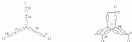
schemat połączeń uzwojeń trójfazowego dla silników dwubiegowych przełączalnych w stosunku 1:2 (układ Dahlandera) (1500/3000 obr/min, 750/1500 obr/min)
