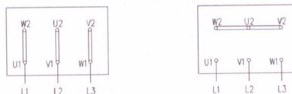
podłączenie przewodów w skrzynce zaciskowej
