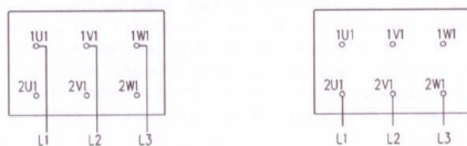
podłączenie przewodów w skrzynce zaciskowej
